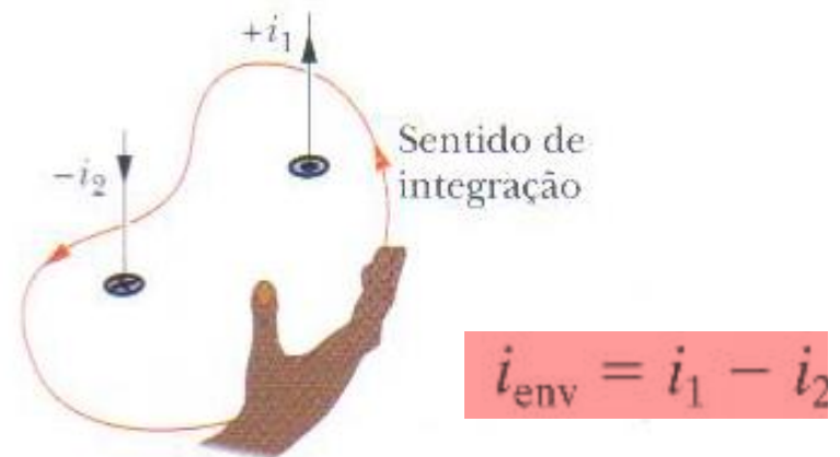
FIG. 29-13 Uso da regra da mão direita da lei de Ampère para determinar os sinais das correntes envolvidas por uma amperiana. A situação é a da Fig. 29-12.
