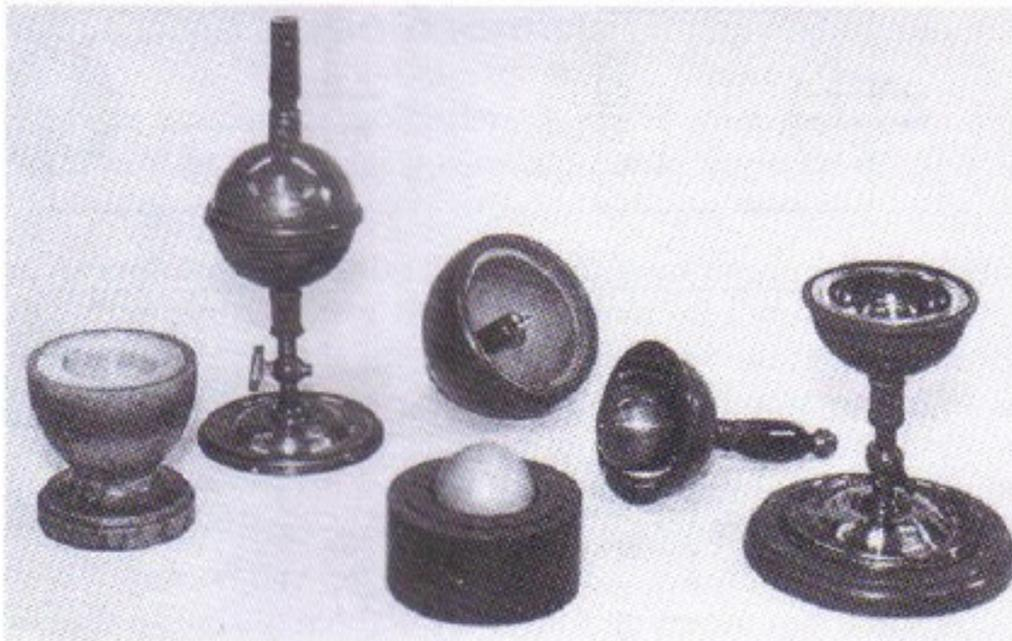
**FIG. 25-13** Equipamento usado por Faraday em suas experiências com capacitores. O dispositivo completo (segundo da esquerda para a direita) constitui um capacitor esférico formado por uma esfera central de bronze e uma casca concêntrica feita do mesmo material. Faraday colocou vários dielétricos diferentes no espaço entre a esfera e a casca. (*The Royal Institute, England/Bridgeman Art Library/NY*)
