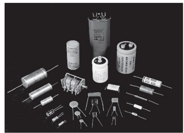
Figura 24.7 Diversos tipos de capacitores disponíveis comercialmente.
