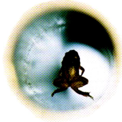
FIG. 32-13 Uma rã sendo levitada pelo campo magnético produzido por um solenóide vertical colocado abaixo da rã. (A rã não está sendo submetida a nenhum desconforto; a sensação é a mesma de flutuar na água, algo que as rãs apreciam muito.) (Cortesia de A. K. Gein, High Field Magnet Laboratory, University of Nijmegen, Holanda)
